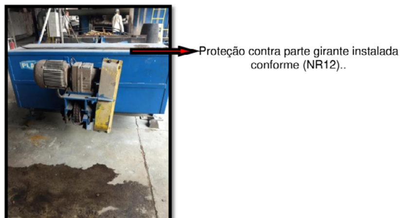
Figura 2 – Proteção de parte girante em equipamento industrial, em conformidade com a NR-12
