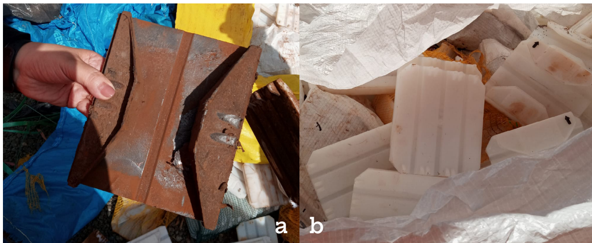
Figura 14 - Isoladores utilizados na via EFVM, sendo (a) Isoladores em fim de vida e (b) Isoladores que sobraram do fardo
