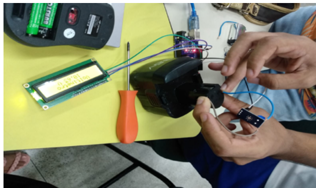
Figura 5 - Circuito do voltímetro com arduino (imagem real)
