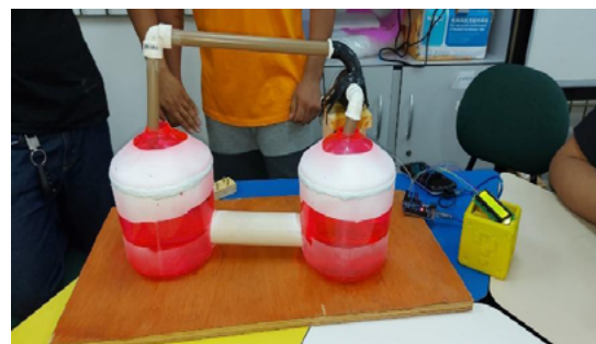
Figura 8 - Bomba d'água caseira vista frontal
