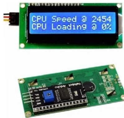
Figura 3 - Display Lcd 16x2 1602 Backlight Azul Com Modulo I2c Arduino
