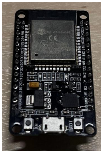
Figura 2 - ESP32 DevKit V1
