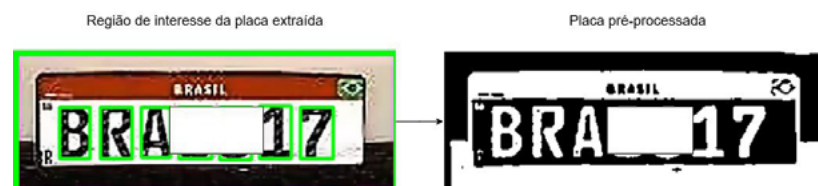
Figura 5 - Identificação da região de interesse e processamento da imagem
