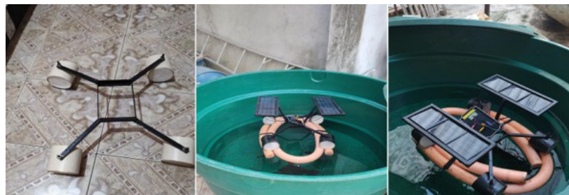
Figura 8 - O dispositivo estável na água com o espaguete flutuador
