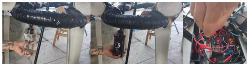
Figura 11 - Checagem do sensor de turbidez
