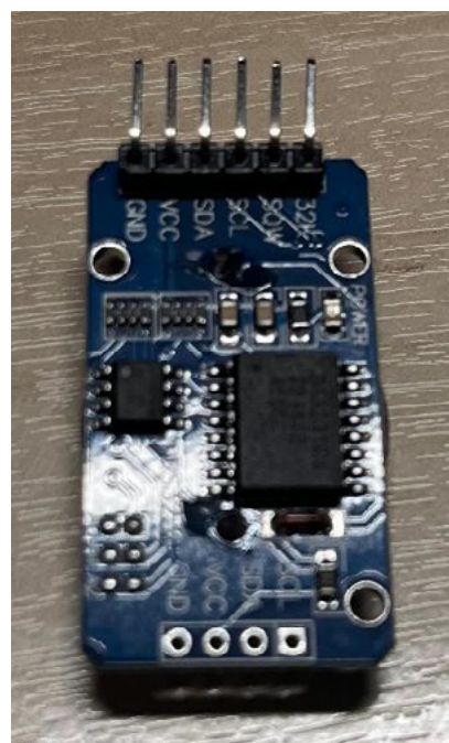
Figura 5 - Real Time Clock RTC DS3231 com Bateria
