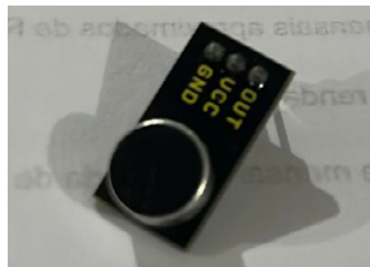
Figura 3 - Microfone de Eletreto + LMV321
