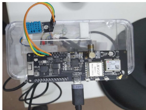
Figura 7 - LILYGO com sensor DHT11
