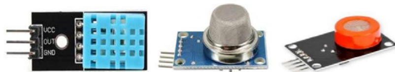
Figura 3 - Sensores DHT-11, MQ-135 e MQ-7
