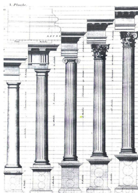
Figura 1 - da esquerda à direita, as ordens clássicas toscana, dórica, jônica, coríntia e compósita
