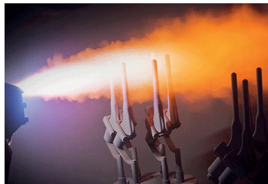
**Figura 13.7** – Recobrimento de implantes metálicos com hidroxiapatita através do método plasma-spray (Vacuum [...], [s.d.]
