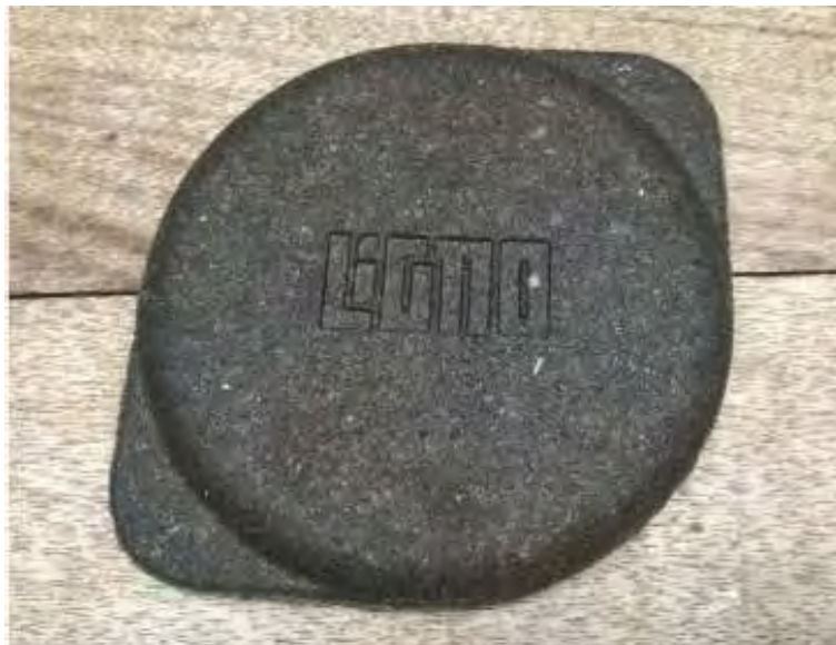
Figura 4 - Porta copo projetado para demonstrar as possibilidades de aplicação da Tecnologia LIGNO, produzido utilizando-se material de outros porta-copos triturados.
