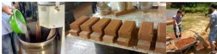
Figura 2 - Atividades do projeto de pesquisa sobre o desenvolvimento de blocos de terra comprimida (2017-2018).
