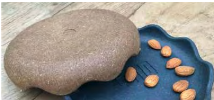
Figura 1 - Bolw projetado para demonstrar as possibilidades de aplicação da Tecnologia LIGNO. O da esquerda foi produzido com resíduos de MDF na cor natural e o da direita, com pigmento colorido.
