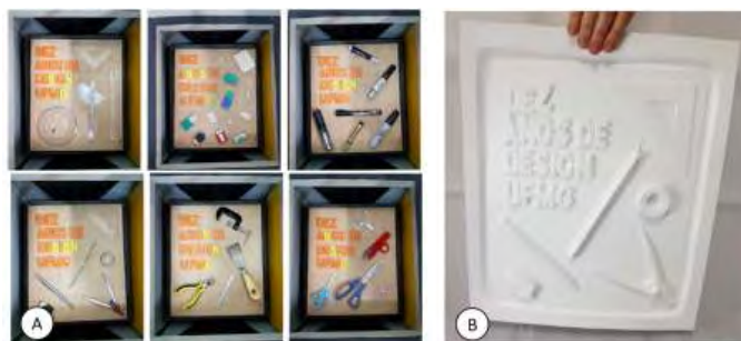
Figura 7 - Cartaz tridimensional com objetos: (A) montagem das peças para termoformagem; (B) exemplo de cartaz pronto.
