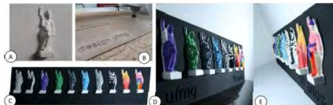
Figura 10 - Reprodução de 10 intervenções do Profeta Abdias: (A) molde termoformado; (B) rebaixo em MDF na CNC; (C, D e E) imagens do artefato final.
