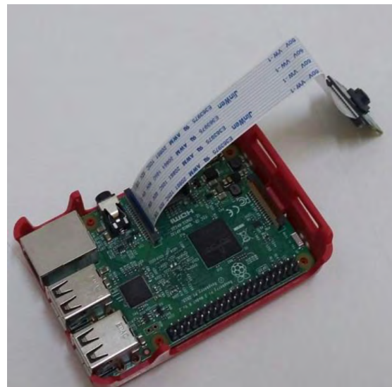
Figura 2. Modelo de Raspberry Pi acoplado com a câmera
